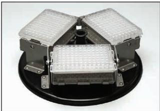
6-Place Microtiter Plate Rotor
